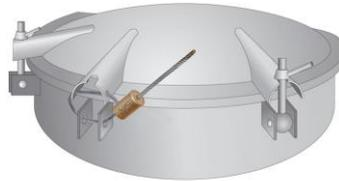
Рис.15 Схема установки ЗПУ «Блок-Гарант-М» на цистерне с крышками загрузочных люков ригельного типа с одной проушиной
