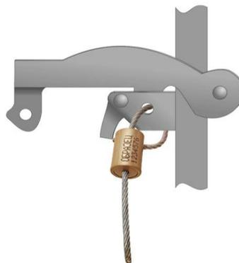
Рис.4 Схема установки ЗПУ «Блок-Гарант-М» на рефрижераторном вагоне завода Дессау или автономном рефрижераторном вагоне
