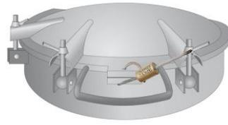
Рис.14 Схема установки ЗПУ «Блок-Гарант-М» на цистерне с крышками загрузочных люков барашкового типа в место одного снятого барашка
