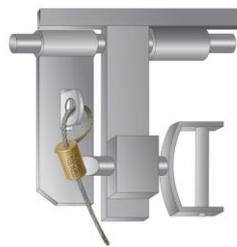
Рис.11 Схема установки ЗПУ «Блок-Гарант-М» на крытом вагоне для перевозки легковых автомобилей с изношенными проушинами и накладной планкой устройства запирания дверей.
