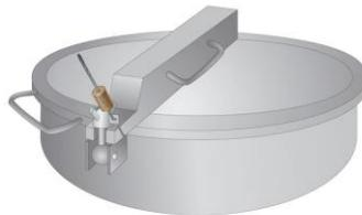
Рис. 16 Схема установки ЗПУ «Блок-Гарант М» на цистерне с крышками загрузочных люков ригельного типа с двумя проушинами.
