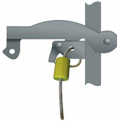
Рис.4 Схема установки ЗПУ «Блок-Гарант 3М» на рефрижераторном вагоне завода Дессау или автономном рефрижераторном вагоне.
