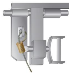
Рис.11 Схема установки ЗПУ на крытом вагоне для перевозки легковых автомобилей с изношенными проушинами и накладной планкой устройства запирания дверей.
