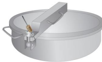
Рис. 16 Схема установки ЗПУ на цистерне с крышками загрузочных люков ригельного типа с двумя проушинами.
